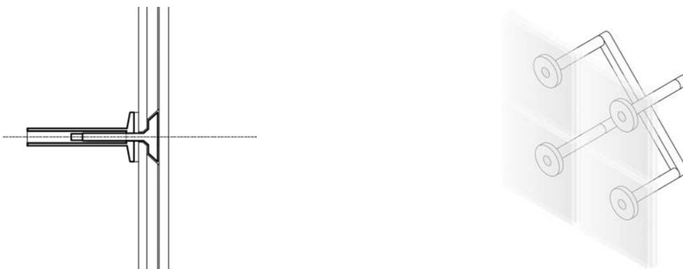
Las fijaciones de anclaje socavadas son fijaciones puntuales mecánicas que permanecen invisibles, ya que el vidrio no se perfora.
