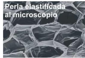
El efecto "muelle" de la elasticación favorece el comportamiento masa + muelle + masa, aportando así poder de aislamiento acústico.
