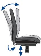
**SINCRO ATOM:** Este mecanismo conjuga el movimiento de rotación del respaldo respecto al asiento situando su centro de giro por encima de la superficie del asiento, muy próximo a la cadera del usuario, asegurando de esta manera un acompañamiento perfecto durante el movimiento de inclinación. 5 posiciones de bloqueo.
