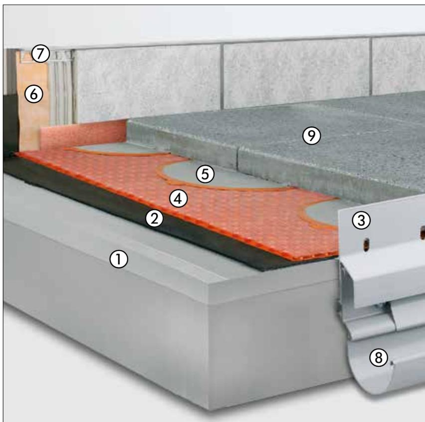
Sobre la impermeabilización se coloca la lámina de drenaje de alto impacto Schlüter®-TROBA-PLUS 8G para evacuar el agua filtrada y como base para las baldosas autoportantes. Además sirve como capa de separación y capa protectora de la impermeabilización. El recubrimiento se coloca en los puntos de encuentro (y según la carga, además en el centro de la baldosa) sobre superficies de colocación de mortero en capa fina definidas y construidas con los anillos reutilizables Schlüter®-TROBA-STELZ-DR.
