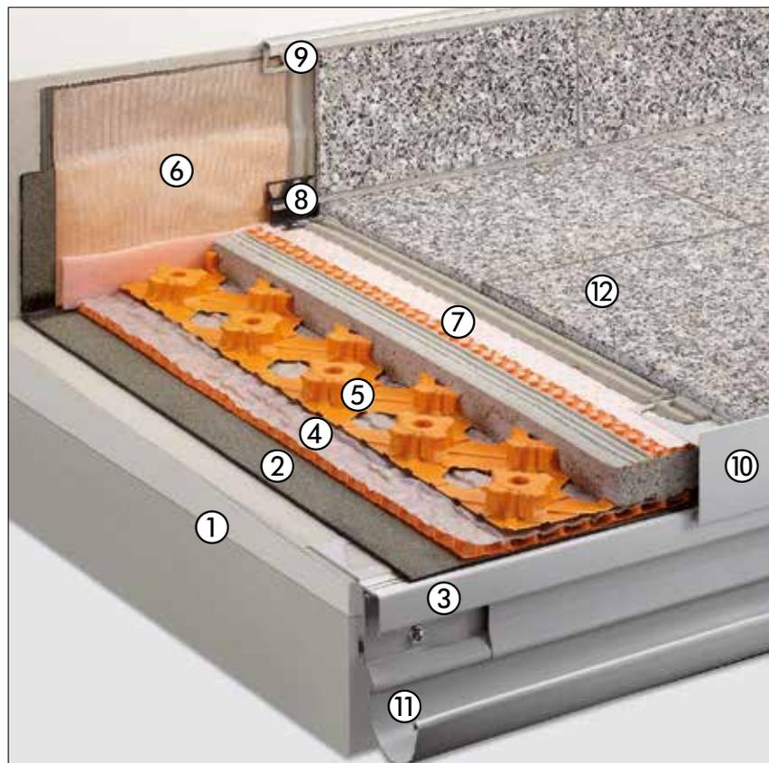
La construcción portante se protege con un sistema de impermeabilización según norma DIN 18195. Entre la impermeabilización y la capa de reparto de cargas realizada en capa fina con el sistema Schlüter®-BEKOTEC-DRAIN, se coloca Schlüter®-TROBA-PLUS como drenaje para evacuar el agua filtrada. La lámina de drenaje con capilaridad pasiva Schlüter®-DITRA-DRAIN favorece la ventilación del revestimiento, facilitando el fraguado uniforme y rápido del adhesivo para baldosas.
